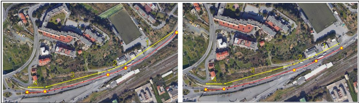
Foto 9 – Suddivisione tratte di intervento (lanci) per la condotta lato monte (sinistra) e lato mare (destra)
